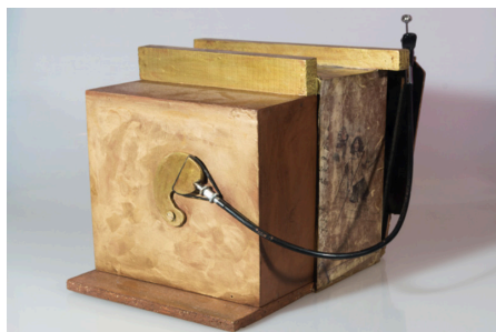
Figura 1. Cámara estenopeica creada para el estudio comparativo
